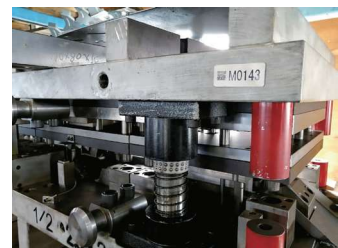
図2 ICタグによる金型管理
